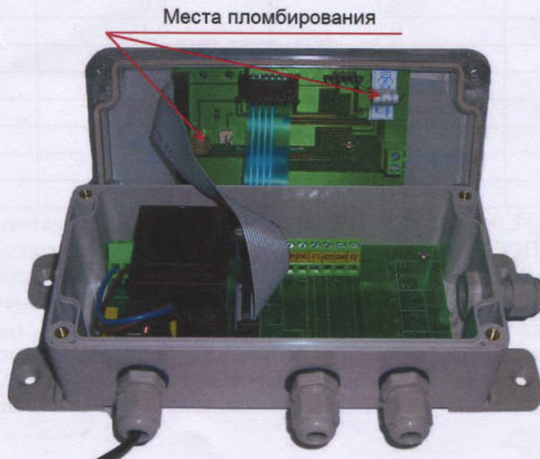
Рисунок 4 – Места пломбирования УВ
